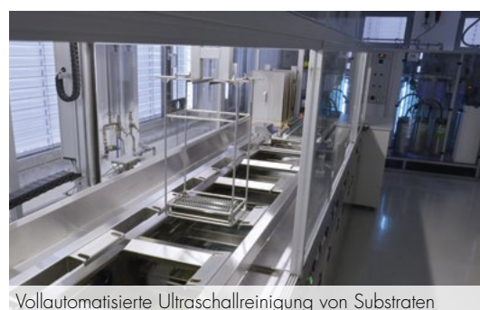
Vollautomatisierte Ultraschallreinigung von Substraten
