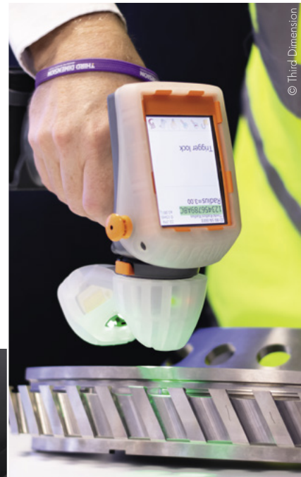
Das tragbare Spaltmesssystem GapGun mit Lasertriangulation reduziert die Arbeitszeit und die Kosten der Fertigungsprozesse erheblich.
