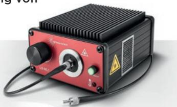
Dafür sorgt die kleine Leuchtfläche von 350 µm, dank der sich der Strahl problemlos in Multimodefasern mit Kerndurchmesser bis zu 1 mm einkoppeln lässt. Der integrierte Mikroprozessor unterstützt werksmäßig vier Betriebsarten: cw, Stroboskop, Pulstriggerung und Modulation. Sie können aber auch selbst ein individuelles Steuerungsmuster mit einer Schaltfrequenz bis zu 100 kHz wählen.
